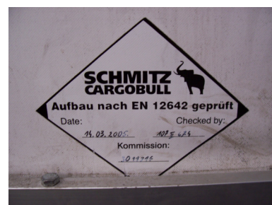
Bild 8 Erkennungsmerkmal für einen EN 12642 Standard Aufbau ohne Verstärkungen
