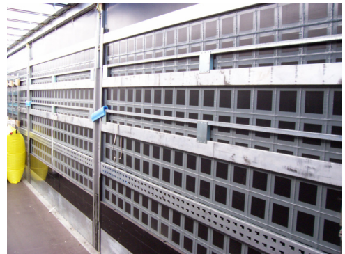
Bild 11 Sehr effektive Seitenkonstruktion mit der Möglichkeit, Quersicherungen formschlüssig mit dem Seitlichen Aufbau zu verbinden.
