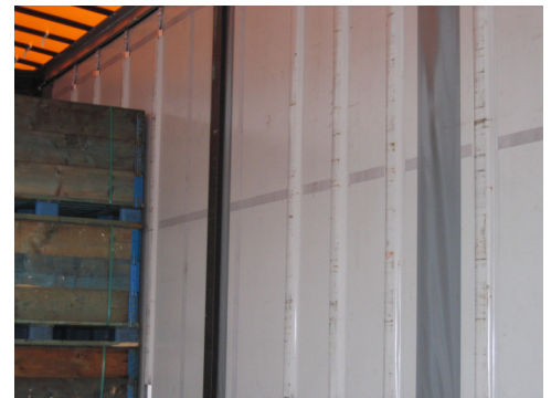
Bild 12, Seitlicher Aufbau mit Aluminiumlattensenkrecht angebracht. Auch dieser Aufbau kann seitliche Kräfte aufbauen.
